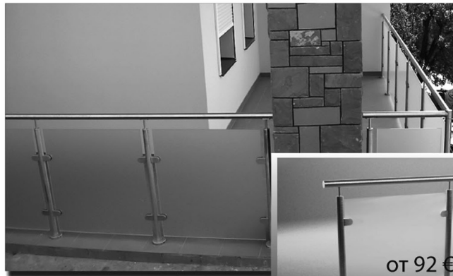
материал сталь 1.4301 (AISI 304) стойка и поручень - труба \varnothing 42.4 заполнение - стекло 6-10 мм
